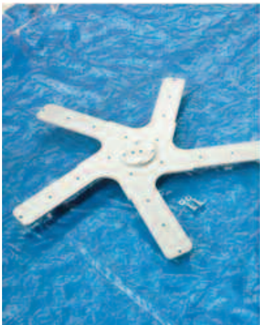
SFILATA LA STELLA SMONTARE IL MOZZO ALBERO
